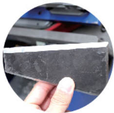
70×100×10mm坡口 Processing case
