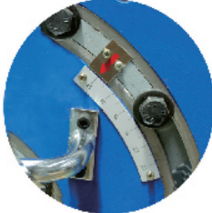
坡口角度任意调节 Bevel Angle: 25°~45°
