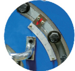
坡口角度任意调节 Bevel Angle: 25°~45°
