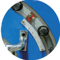
坡口角度任意调节 Bevel Angle: 25°~45°
