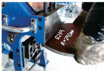
加工Φ500mm圆弧板 Processing Φ500mm arc plate
